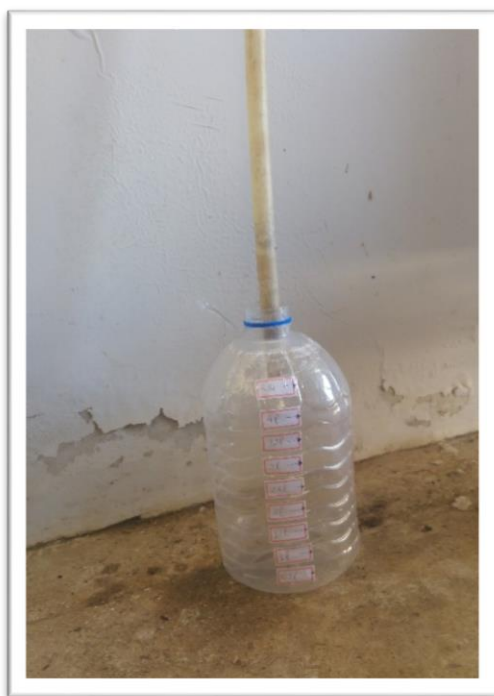
Figura 03 – Medição do bloco administrativo (dreno no mini depósito) Fonte: Acervo pessoal
